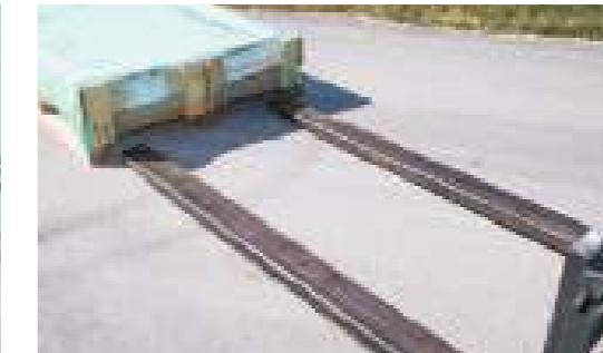
PER MOVIMENTARE CORRETTAMENTE IL PALLET SUL LATO CORTO (AD ESEMPIO NELLO SCARICO DEI CONTAINERS) È RACCOMANDATO L'UTILIZZO DI FORCHE LUNGHE ALMENO 2,5 MT, QUESTO GARANTISCE UNA PERFETTA PRESA E SICUREZZA DEL MATERIALE.
