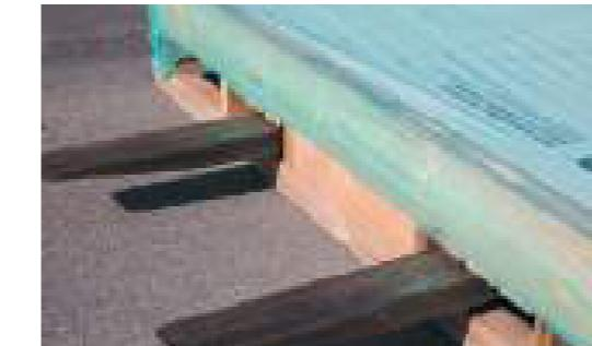
PER MOVIMENTARE CORRETTAMENTE IL PALLET SUL LATO LUNGO SI RACCOMANDA DI ALLARGARE AL MASSIMO LE FORCHE E DI POSIZIONARLE AL CENTRO DEL PALLET, FAR PRESA SU TUTTA LA PROFONDITÀ PRIMA DI SOLLEVARE.
